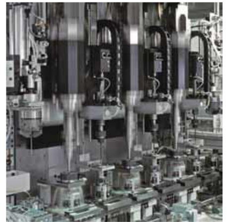
ソーラトロン工場のマシニングセンター 精度 1 μm 以上のプローブ部品を製造
