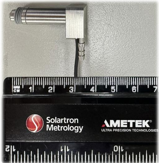
ソーラトロンメトロロジーは、測定レンジが2mmで、長さ36mmという世界で最も短いエアー作動式ゲージプローブをご紹介します。
